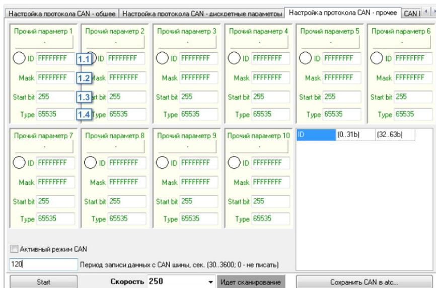
Рис.52. Вкладка «Настройка протокола CAN – прочее».
