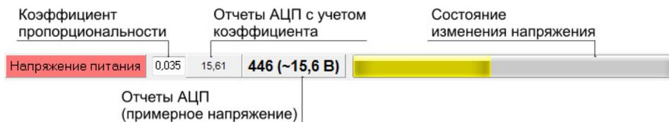
Рис.63. Основное напряжение питания прибора.
