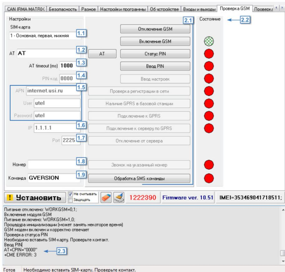
Рис.67. Вкладка Контроль. Проверка GSM.
