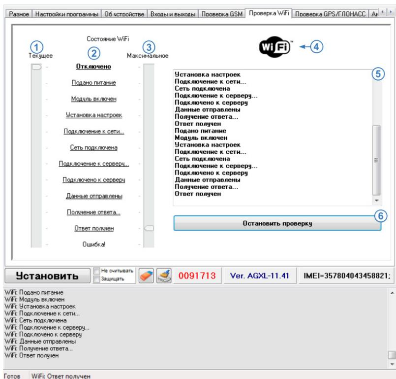
Рис.69. Вкладка Контроль. Проверка WiFi.
