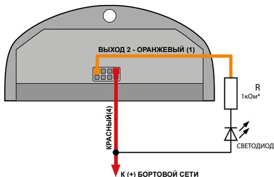
\* Для напряжения питания бортовой сети 24 В:  $R = 1 \dots 2 \text{ кОм}$ .
