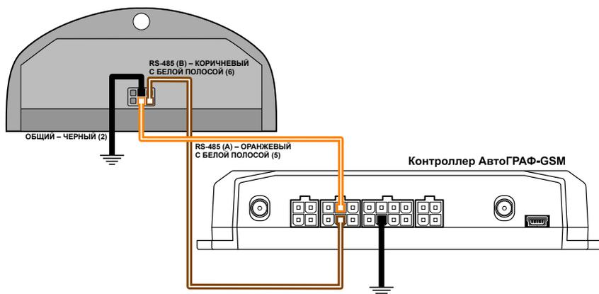
Контроллер АвтоГРАФ должен быть также настроен на работу с устройством «АвтоГРАФ-CardReader». Настроить контроллер пользователь может при помощи программы GSMConf версии 3.2.7-r4 и выше или посредством SMS и серверных команд.
