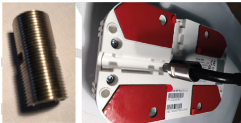
Рис.11. Установка шлицевой головки.
