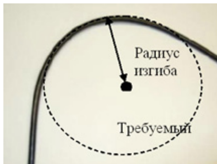
Рис.13. Рекомендуемый радиус изгиба кабеля.
