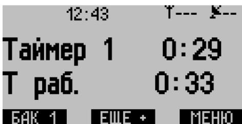
Рис.22. Индикация таймеров на рабочем экране.
