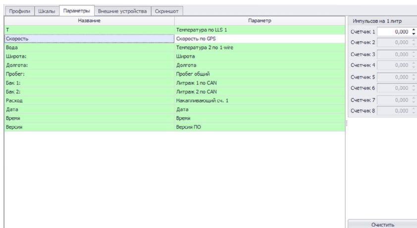
Рис.6. Список параметров для вывода на рабочий экран.
