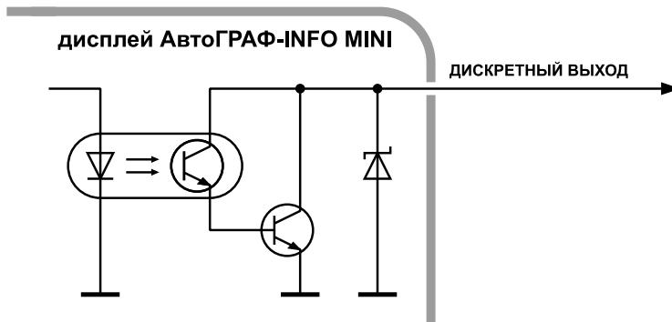
**Внешняя схема подключения выхода:**
