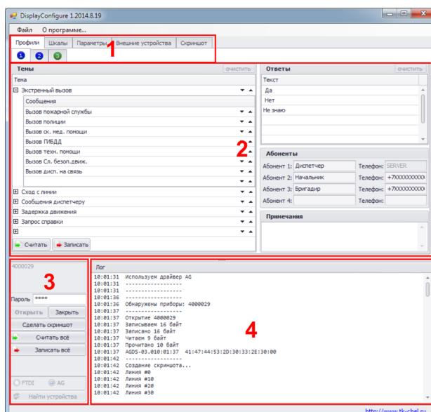
Рис.34. Программа «DisplayConfigure».
