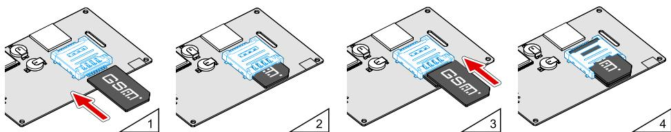
SIM-карта, установленная в нижний слот SIM-держателя, является основной. Прибор «АвтоГРАФ-GSM/SL-2» после включения начинает работу с этой SIM-картой. SIM-карта, установленная в верхний слот SIM-держателя, является резервной. Прибор переключается на резервную SIM-карту, если недоступна основная – заблокирована, повреждена или отсутствует.
