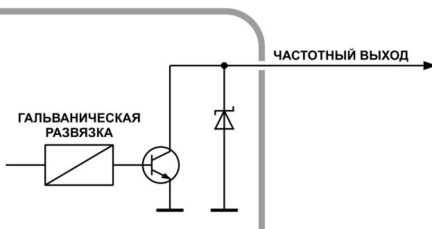
Рис.14. Внутренняя схема частотного выхода датчика уровня топлива TKLS.
