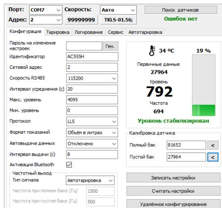
Рис.8. Калибровка датчика. Установка значения «Пустой бак»
