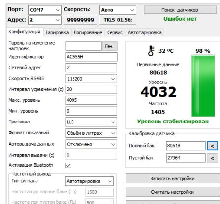
Рис.9. Калибровка датчика. Установка значений «Полный бак»
