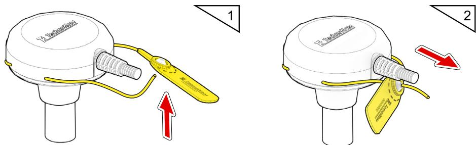
Рис.23. Пломбировка корпуса датчика
