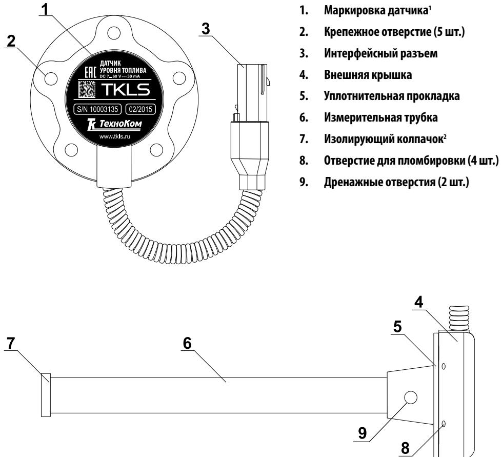
Рис.2. Составные части датчика уровня топлива TKLS
