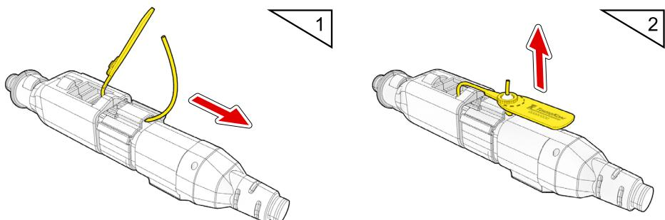
Рис.24. Пломбировка интерфейсного разъёма датчика
