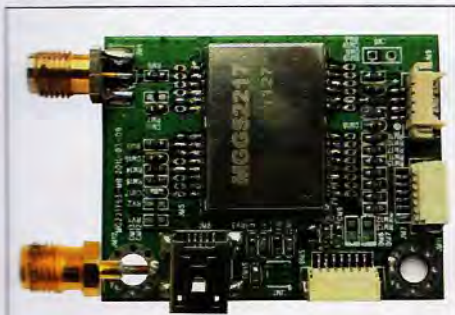
Рис. 2. Отладочный комплект на базе навигационного модуля MGGS2217
