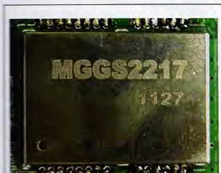
Рис. 3. Навигационный модуль ГЛОНАСС/GPS MGGS2217
