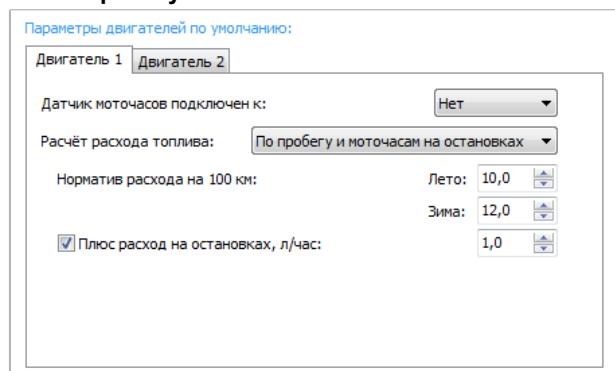
Рис.57 – Расход по пробегу и моточасам на остановках.
