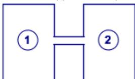
В каждом баке для измерения уровня топлива подключено по 1 датчику. Общий объем топлива в системе сообщающихся баков – это сумма уровней топлива в двух баках, соответственно сумма показаний двух датчиков. Поэтому делитель равен 1.
