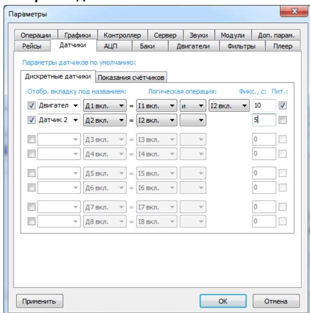
Рис. 53 – Дискретные датчики.
