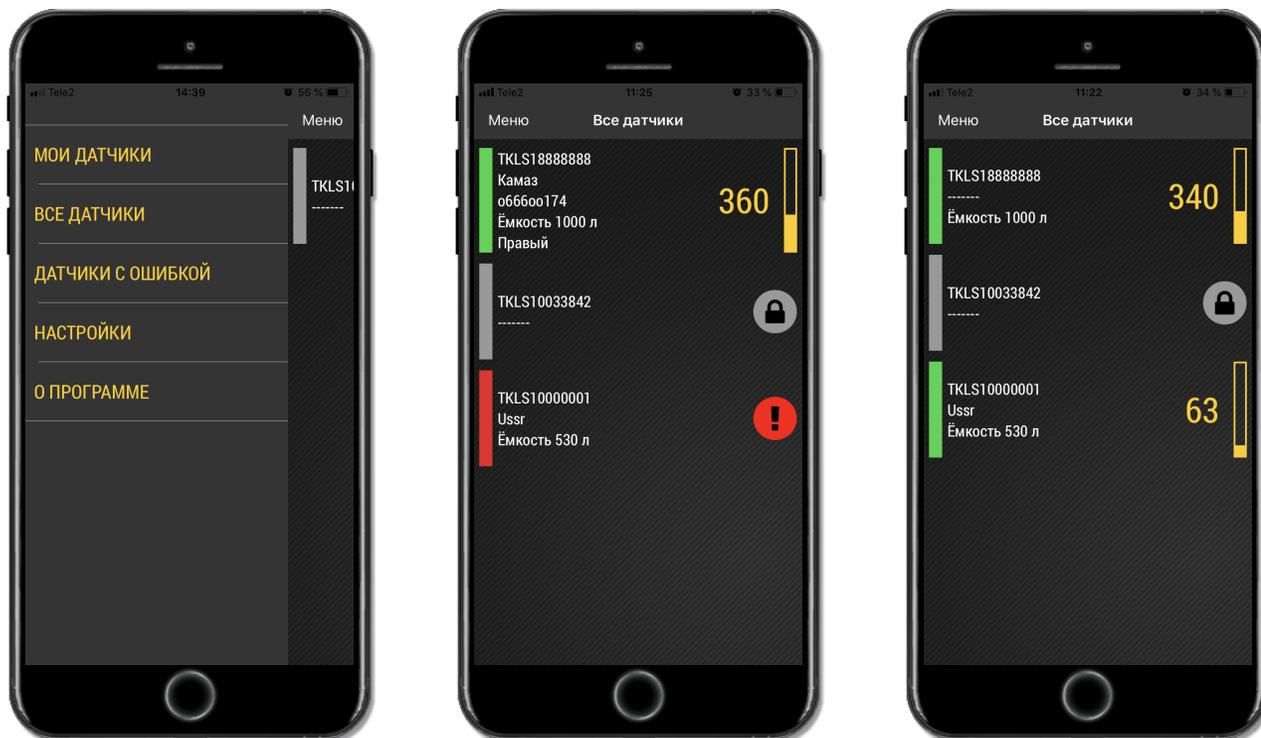
Приложение TKLS Monitor позволяет увидеть пользователю все датчики уровня топлива TKLS в пределах зоны действия Bluetooth мобильного устройства.
