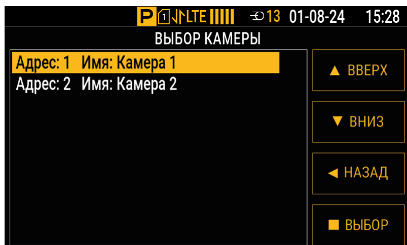
Рис.88. Список адресов камер, настроенных в контроллере
