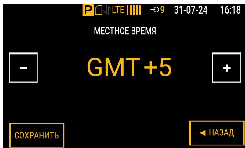
Рис.28. Установка часового пояса в контроллере
