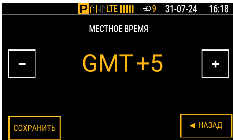
Рис.28. Установка часового пояса в контроллере
