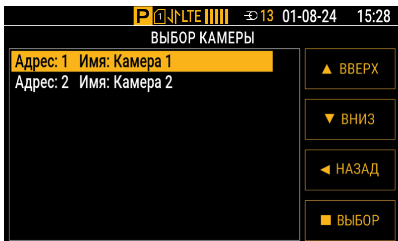
Рис.88. Список адресов камер, настроенных в контроллере
