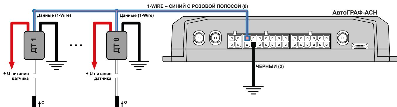
Рис.21. Схема подключения к шине 1-Wire
