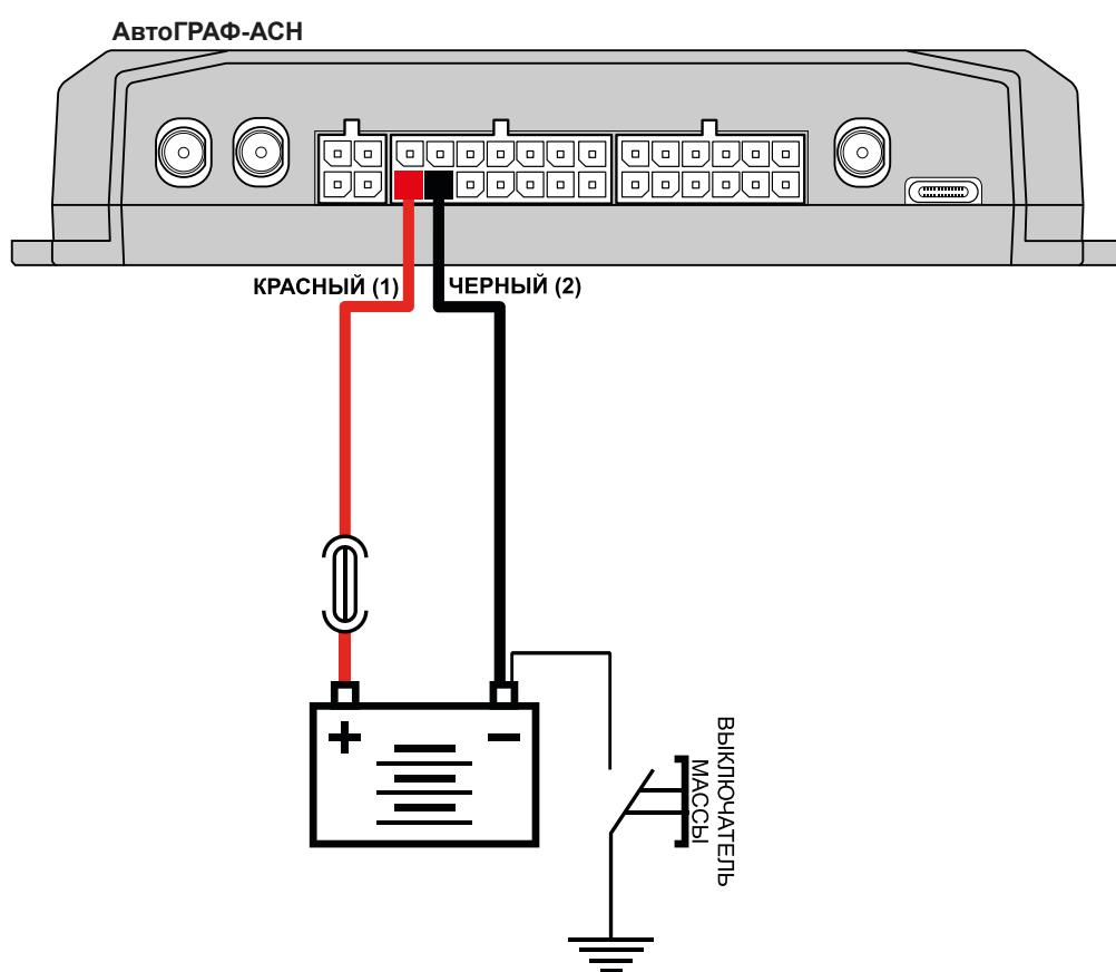
Рис.6. Подключение питания до выключателя массы
