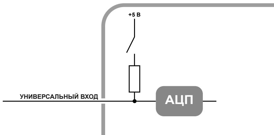
Рис.11. Внутренняя схема универсального входа
