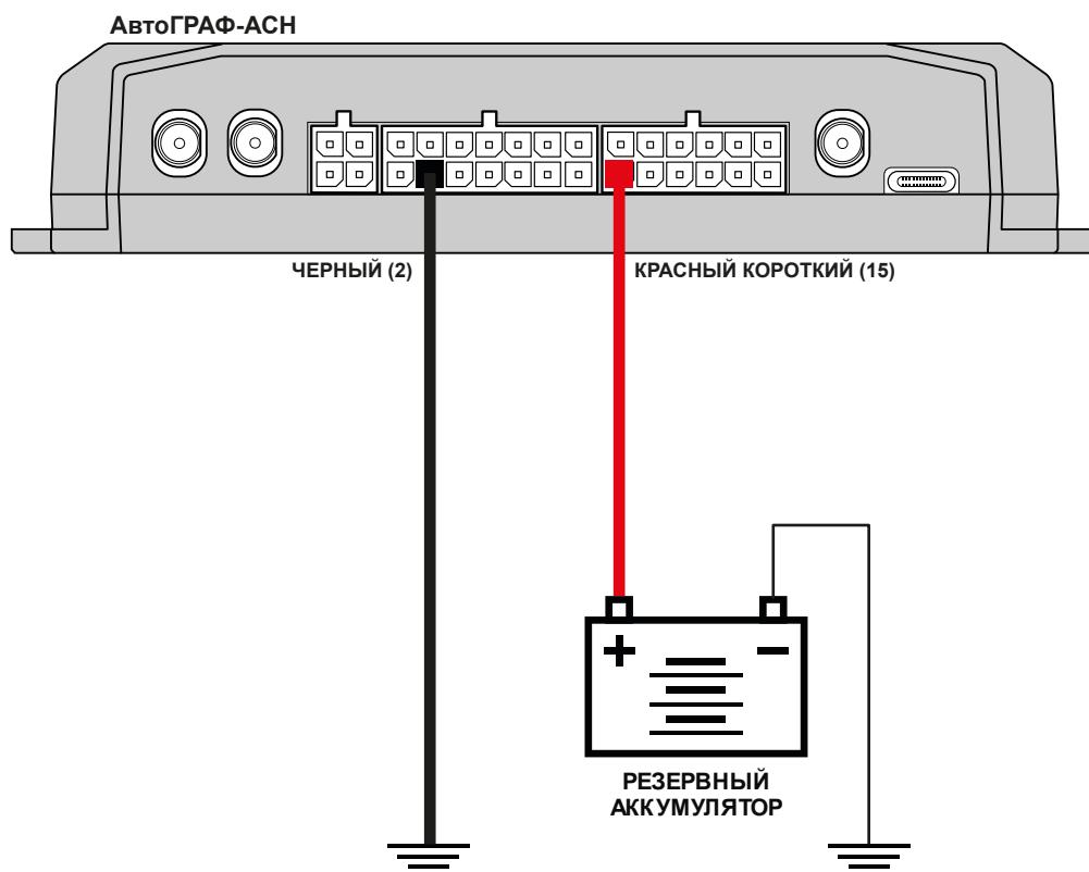
Рис.10. Установка резервного аккумулятора
