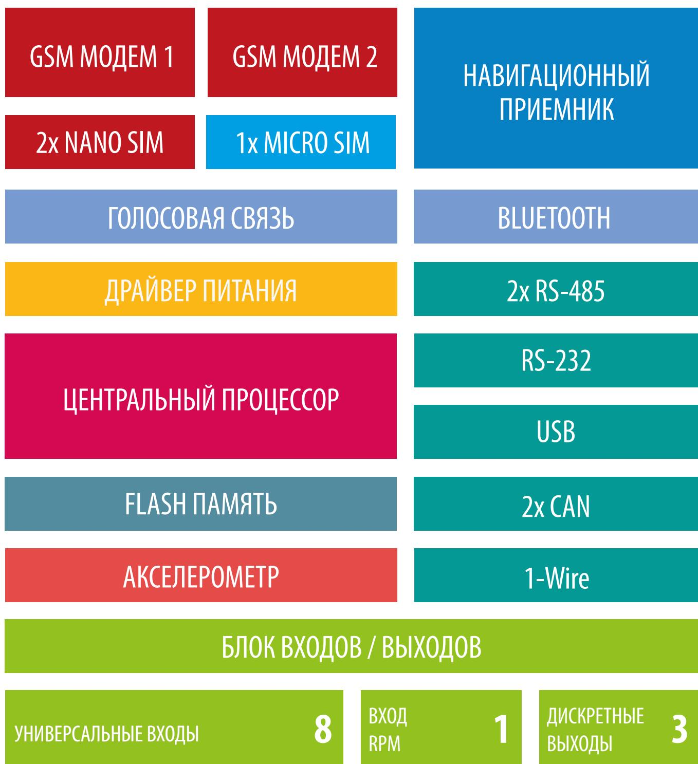
Рис.1. Функциональная схема
