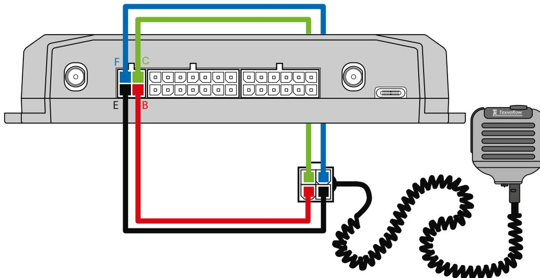
**Рис.21. Схема подключения устройства громкой связи ГС-4**
