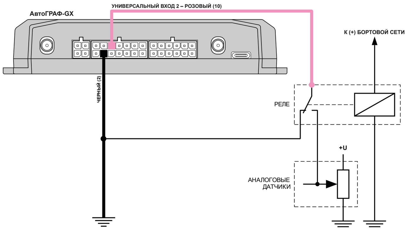
Рис.14. Подключение аналоговых датчиков к универсальному входу (схема с защитой от разрыва «массы»)
