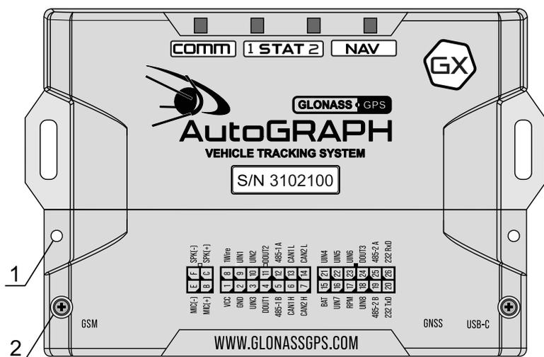
1. Отверстие для опломбировки (2 шт.)
