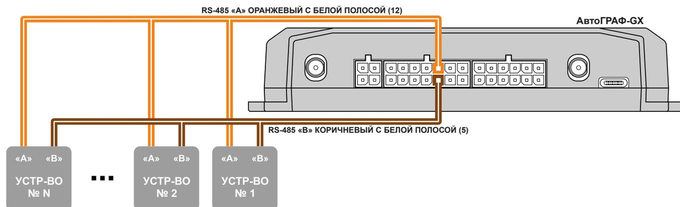
Рис.17. Схема подключения по шине RS-485
