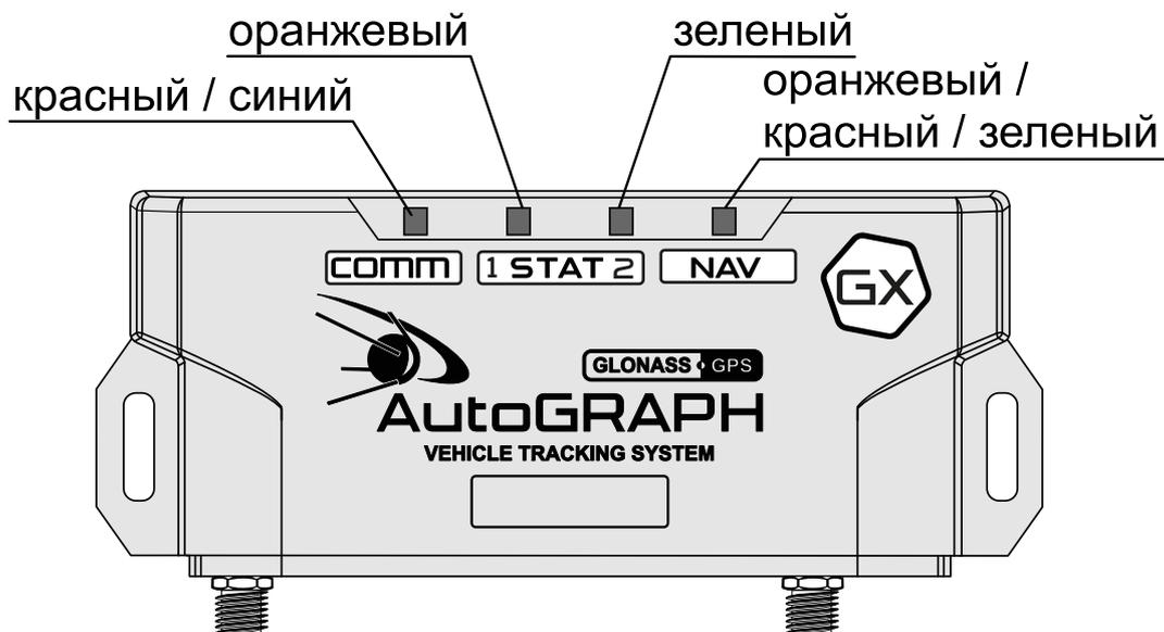
Рис.7. Индикация контроллера
