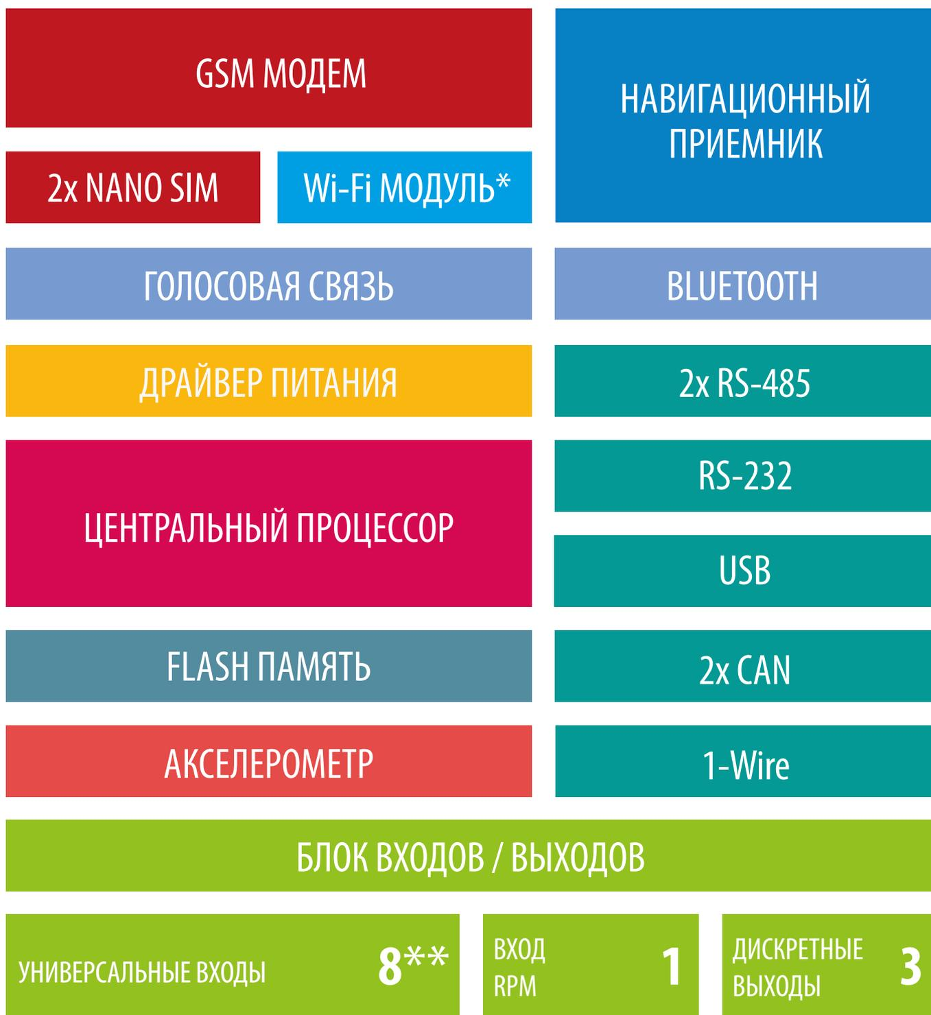
Рис.1. Функциональная схема
