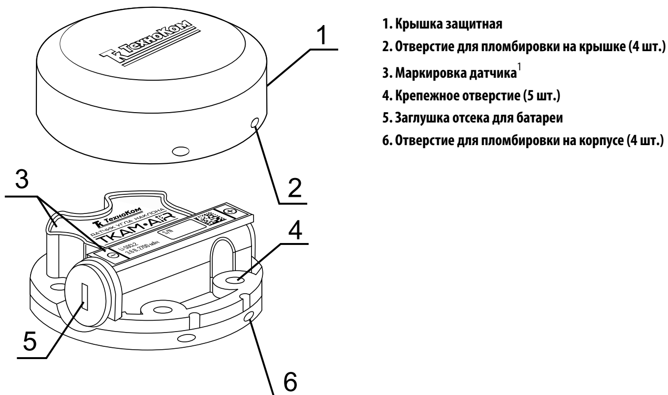
Рис.2. Составные части датчика
