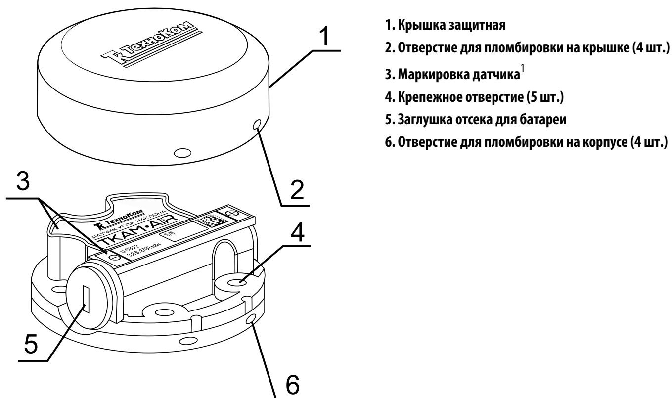
Рис.2. Составные части датчика
