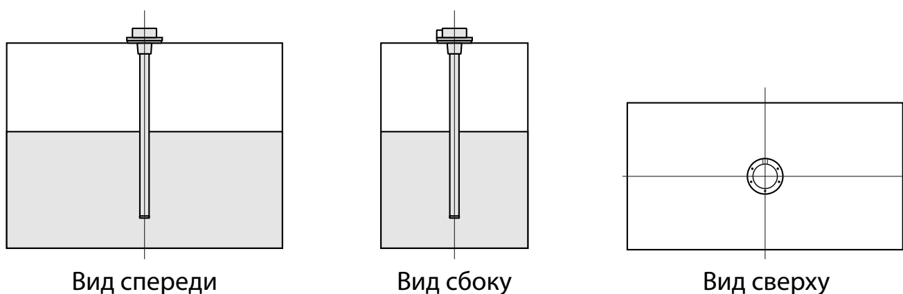
Рис.3. Рекомендованные варианты установки датчика в бак
