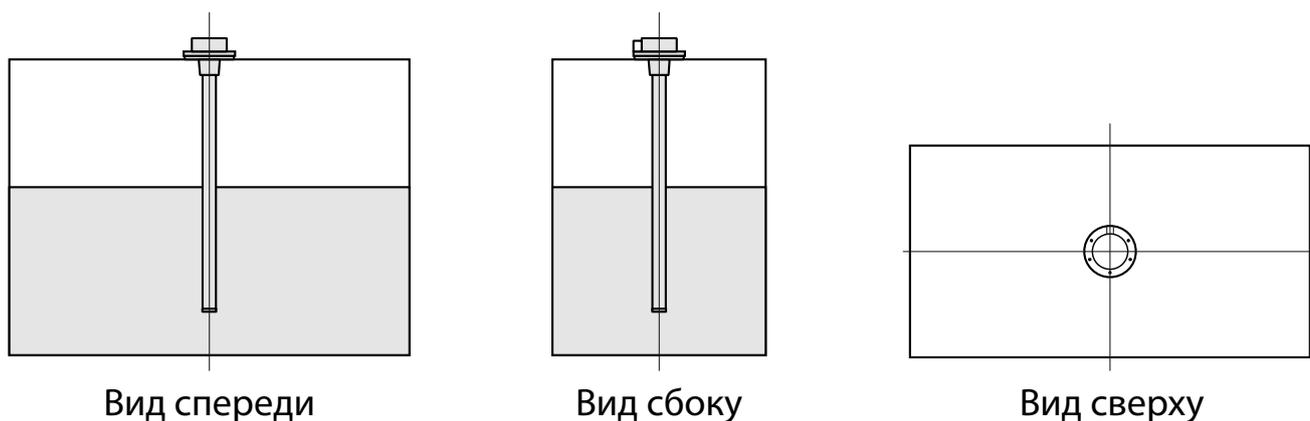
**Рис.3.** Рекомендованные варианты установки датчика в бак
