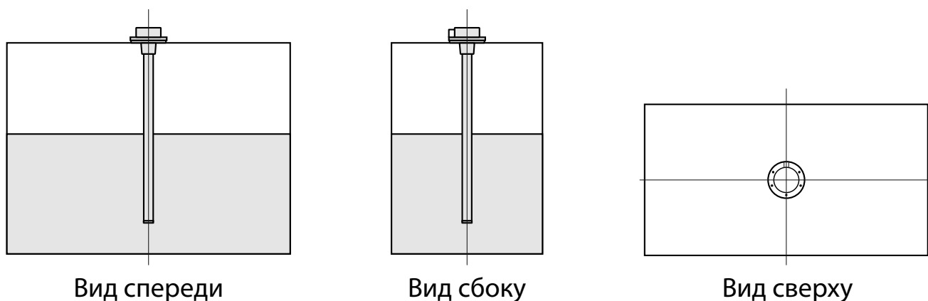
Рис.3. Рекомендованные варианты установки датчика в бак
