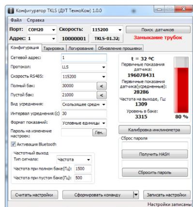
Рис.5. Диагностика датчика в программе «Конфигуратор TKLS».
